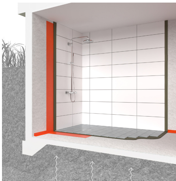
BILD A – Källare med tillskjutande markfukt
