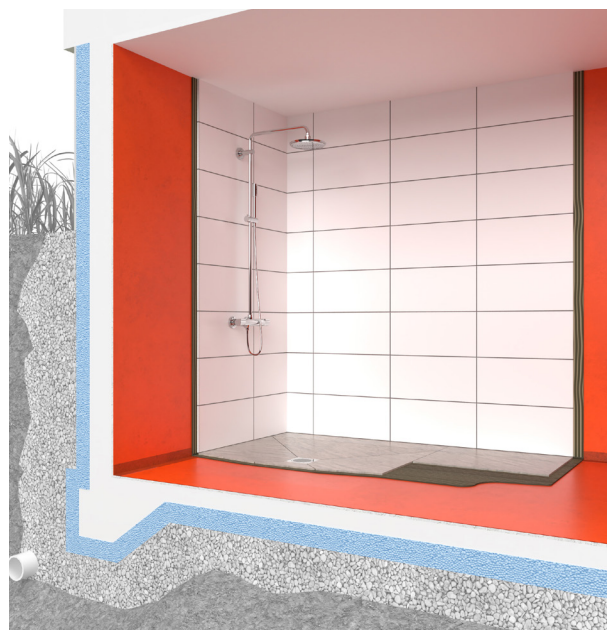
BILD B – Källare utan tillskjutande markfukt
