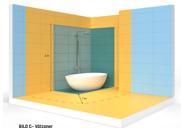
BILD C – Våtzoner ■ Våtzon 1 ■ Våtzon 2 ■ Plats för bad eller dusch
